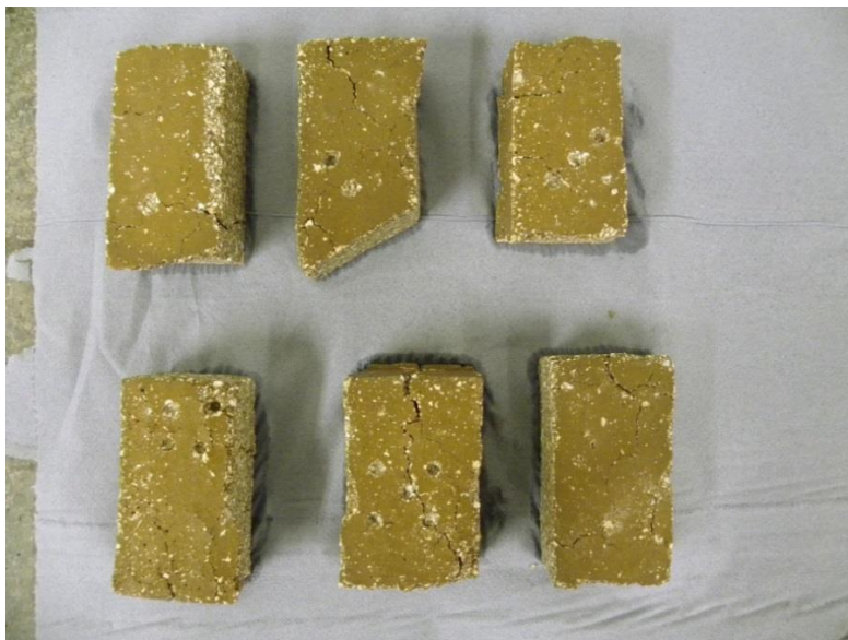
Abbildung 16: EcoMag FFS 91Z (nicht konditioniert) nach dem 1. Anheiz- und Abkühlzyklus (Entfärbung, deutliche Rissbildung).
