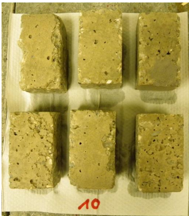
Abbildung 24: EcoMag HSM 79A (konditioniert) nach dem 10. Anheiz- (350 °C) und Abkühlzyklus (Abplatzen von einzelnen Körnern und Feinanteil, Probe intakt).
