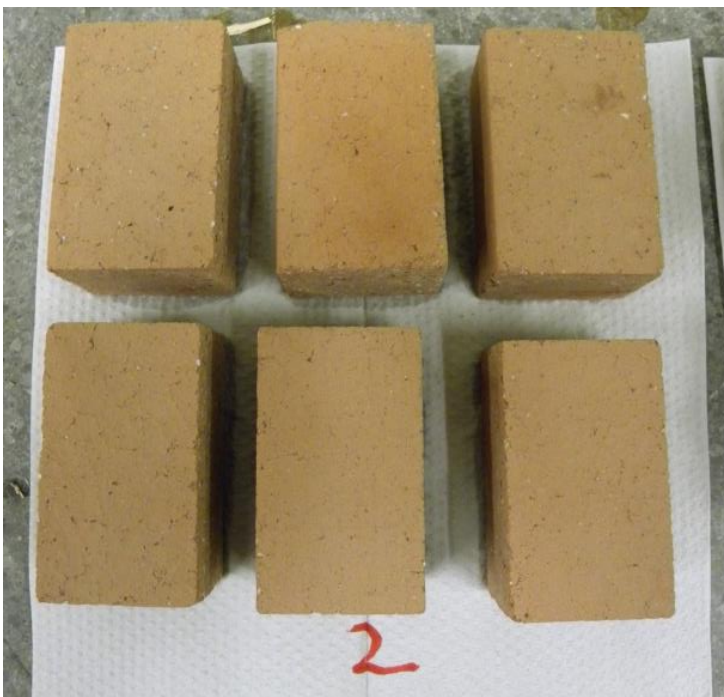
Abbildung 20: Schamotte HBO+ (konditioniert) nach dem 2. Anheiz- und Abkühlzyklus (unverändert im Vergleich zu Zyklus 1, Probe intakt).
