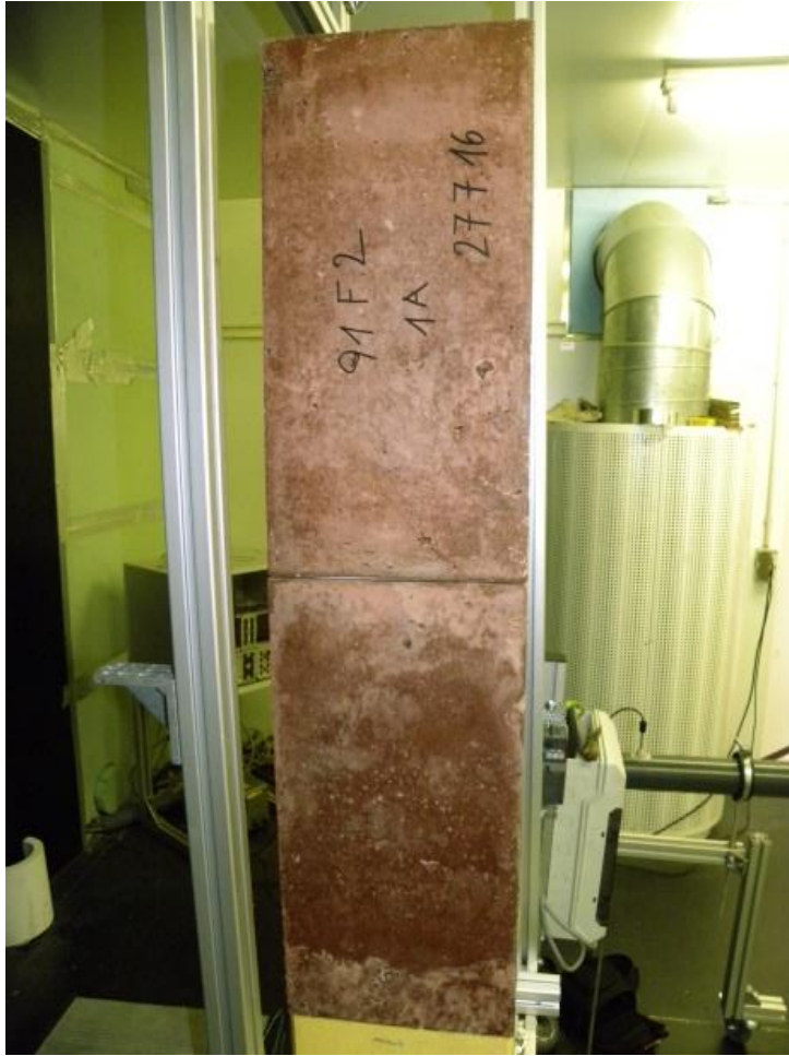
Abbildung 8: Im Versuchsstand installierter Probekörper-91F.2 (Höhe=1,08 m; Gewicht=85,2 kg).
