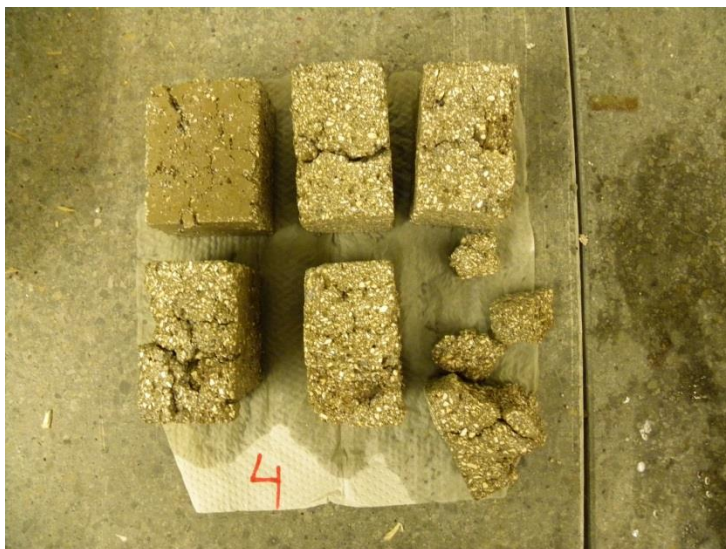
Abbildung 26: EcoMag FFS 91F.2 (konditioniert) nach dem 4. Anheiz- und Abkühlzyklus (Probe zerstört).
