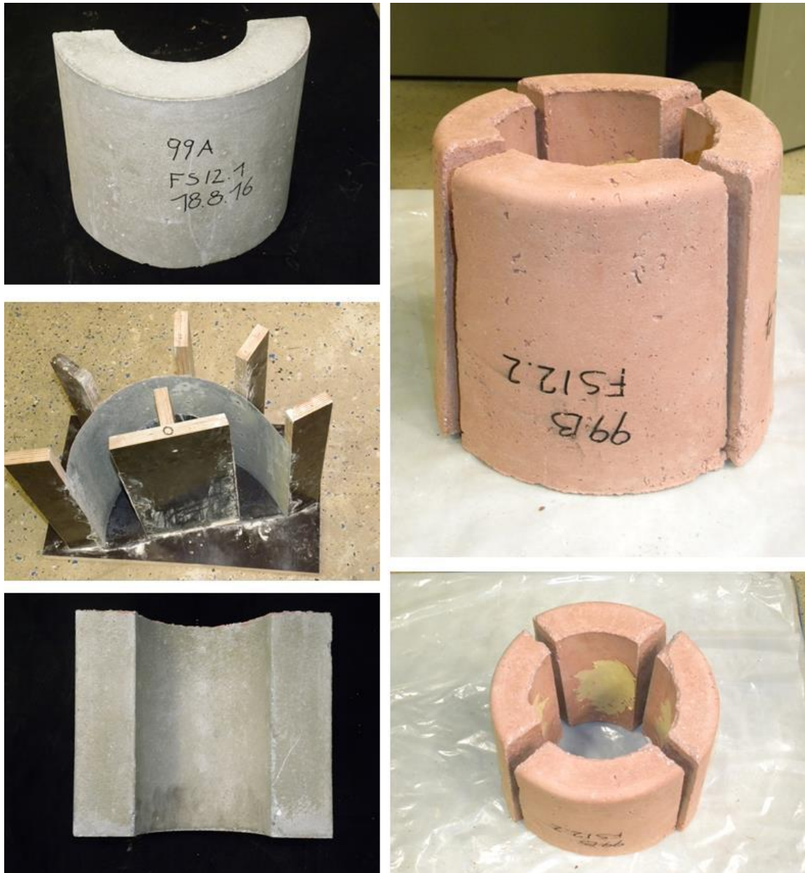
Abbildung 12: Hergestellte Speichermodule; Anmerkung: linke Seite = HSM 99A sowie die Gussform für den Probekörper (Masse: 35,1 kg bestehend aus zwei Teilen); rechte Seite = HSM 99B (Masse: 23,0 kg bestehend aus vier Teilen).
