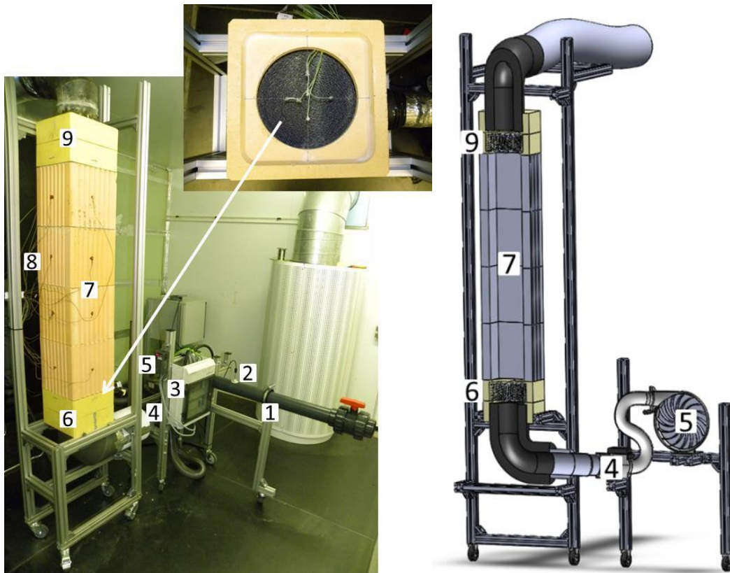
Abbildung 4: Links: Versuchsstand des Fraunhofer-Instituts für Bauphysik IBP für Messungen unter reproduzierbaren Bedingungen zur Entwicklung ökologischer Speichersteine als Schamottersatz für den Einsatz in biomassebetriebenen Einzelraumfeuerungsanlagen. Rechts: CAD-Schnittzeichnung des Versuchsstands.
