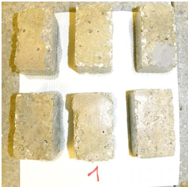
Abbildung 23: EcoMag HSM 79A (konditioniert) nach dem 1. Anheiz- (350 °C) und Abkühlzyklus (Abplatzen von einzelnen Körnern und Feinanteil).
