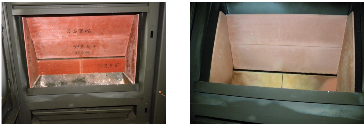
Abbildung 10: EcoMag Feuerraumauskleidung FFS 91Z; Anmerkung: links: Rohzustand; rechts: Nach dem ersten Heizbetrieb.
