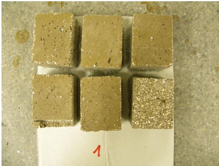
Abbildung 25: EcoMag FFS 91F.2 (konditioniert) nach dem 1. Anheiz- und Abkühlzyklus (Entfärbung, Geruchentwicklung, oberflächliche kleine Risse).
