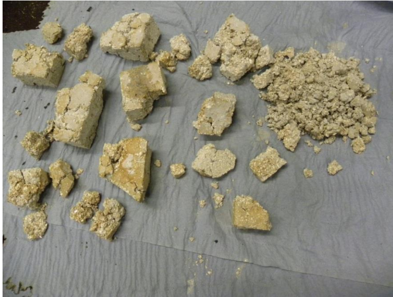
Abbildung 17: EcoMag FFS 91Z (nicht konditioniert) nach dem 2. Anheiz- und Abkühlzyklus (Zerstörung der Proben).
