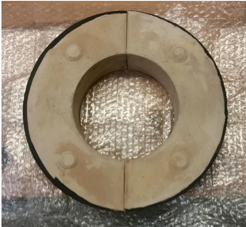
Abbildung 11: Original Speichermodul aus Schamott (2 von insgesamt 8 Speichersteinen).
