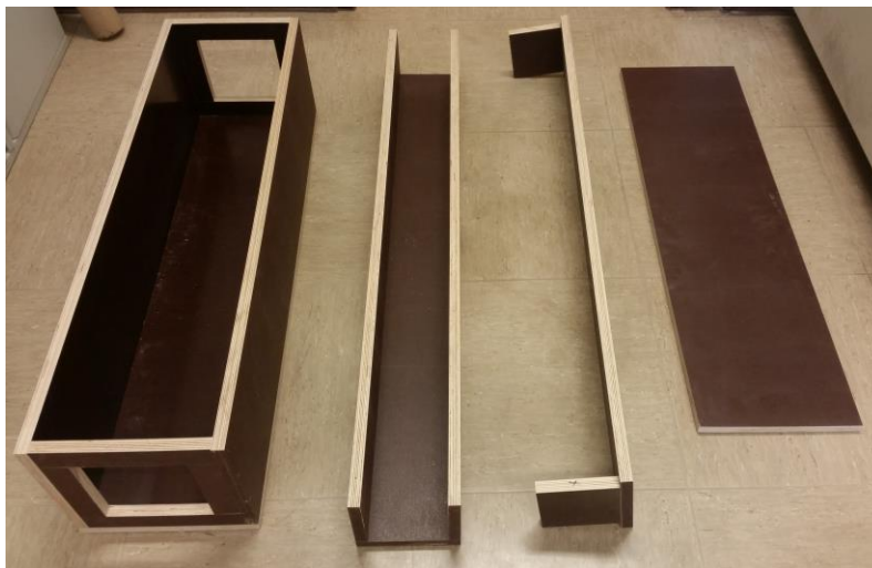
Abbildung 5: Gussform/Verschaltung zur Herstellung der Probekörper.
