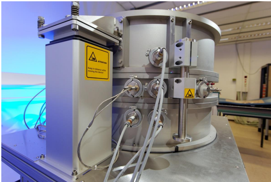
Abbildung 2: Plattengerät zur Bestimmung der Wärmeleitfähigkeit.
