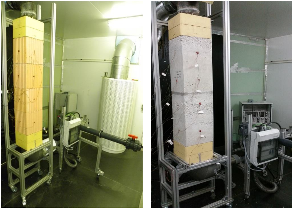
Abbildung 6: Im Versuchsstand installierte Probekörper; links: Probekörper-HBO+ (Höhe=1,08 m; Gewicht=80,8 kg), rechts: gegossener Probekörper-HSM79A (Höhe=1,08 m; Gewicht=82,7 kg).
