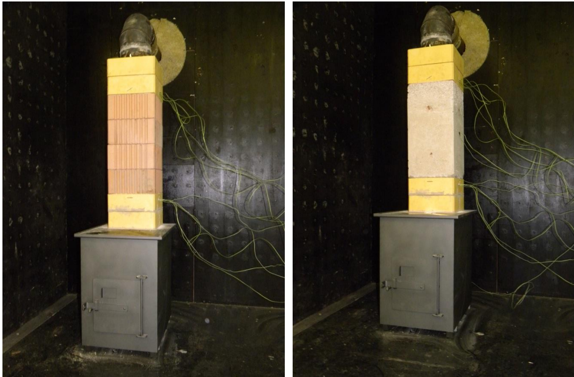
Abbildung 14: Auf dem Herd installierte Speichermodule (direkte Wärmeübertragung); Anmerkung: links = Schamott(HSM)-Speichermodul (Masse: 50,1 kg), rechts = EcoMag 79A-Speichermodul (Masse: 42,2 kg), nicht abgebildet = EcoMag 91.F-Speichermodul (Masse: 43,5 kg).
