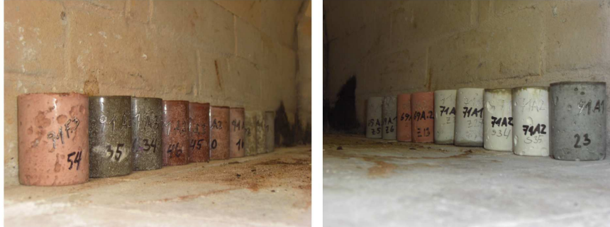
Holzbrand 5 Stunden 600°C, nachfolgend 24 Stunden Abkühlzeit, dann Messung...
